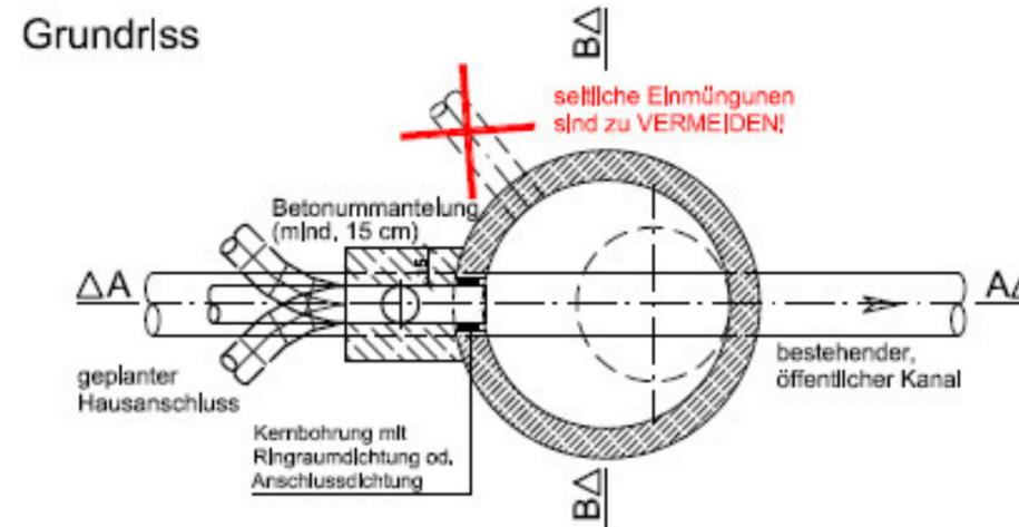
Ringraumdichtungen und Anschlussdichtungen (Beispiele)
